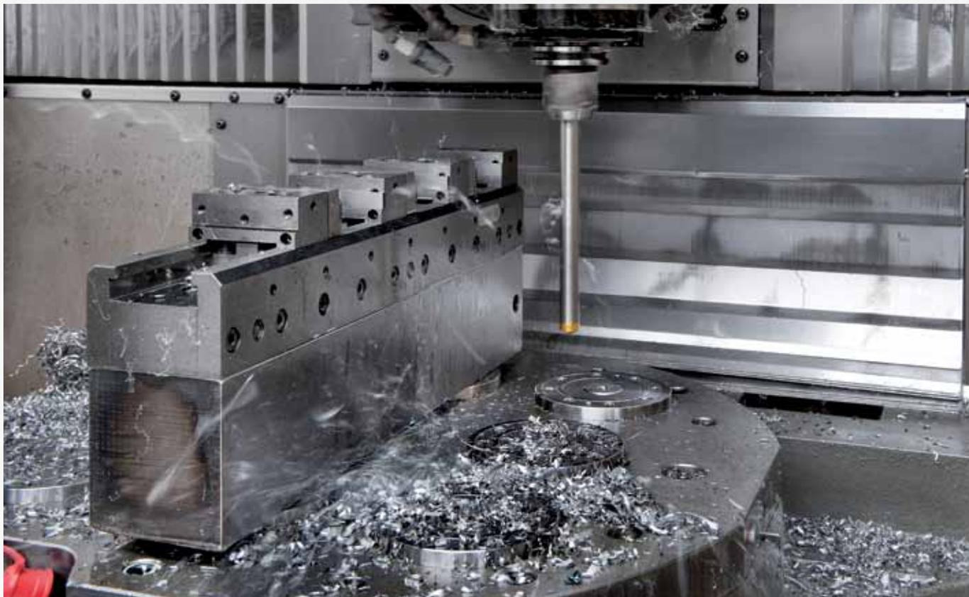
Очистительная система AMF в действии: автоматизированная очистка зажимного приспособления и стола станка
