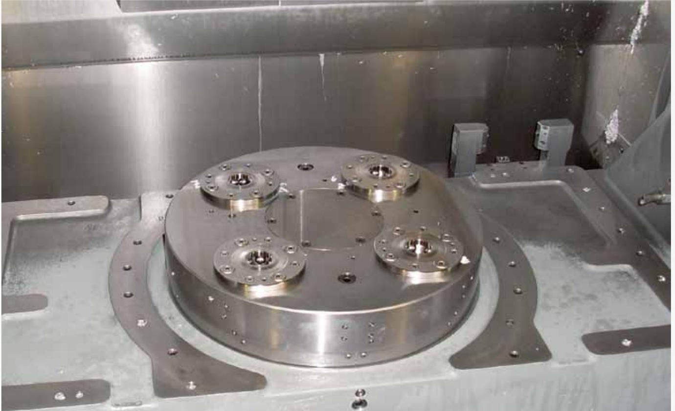
Решение по автоматизации (арт. № 427161) с блоками контроля блокировки и прилегания, а также контролем ниппеля при применении в полностью автоматизированном технологическом процессе с роботизированной погрузкой.
