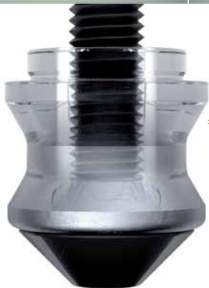
> Зажимной ниппель в нашей системе ZPS является интерфейсом между машинным столом и заготовкой или устройством. Он обеспечивает точное базирование и надежный зажим. Силы, возникающие при обработке, переносятся через зажимной ниппель на зажимной модуль.
