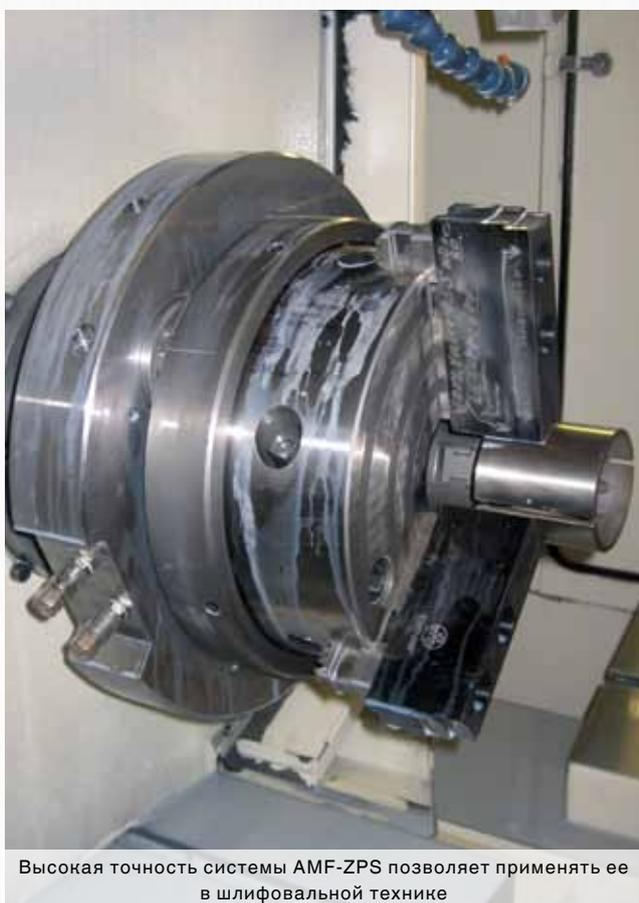
Высокая точность системы AMF-ZPS позволяет применять ее в шлифовальной технике
