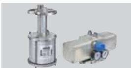
> Гидравлический редуктор Он преобразует пневматическое давление в гидравлическое в соотношении 1:8 для открытия гидравлических зажимных модулей. Пневматический усилитель давления Он служит для усиления пневматического давления в соотношении 1:2 в пневматических зажимных модулях и компенсирует колебания давления в питающей линии.
