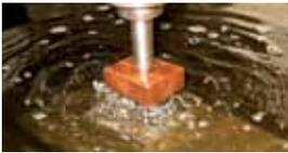
> Модуль наилучшим образом пригоден для всех известных типов обработки, таких как: электроэрозионная обработка, шлифование, фрезерование и сверление. Полная герметичность позволяет использовать зажимной модуль в жидкостях и в суровых окружающих условиях.
